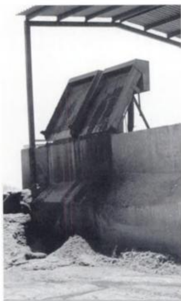
Separadores de cascada
